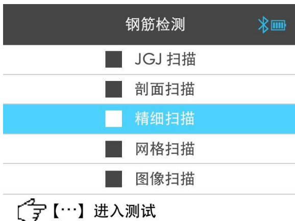
图 4.3 钢筋检测界面
