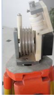
图 F1.3 深度记录装置安装
