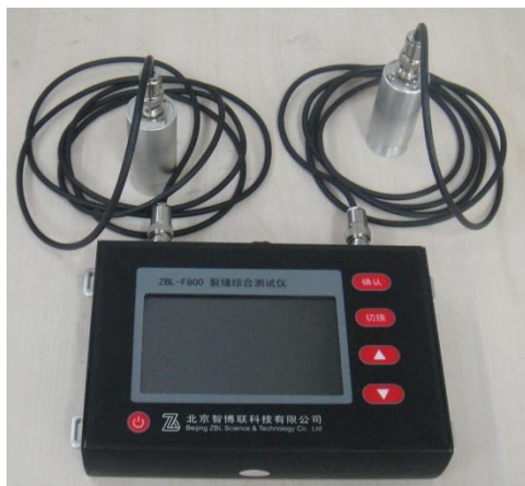
图 4.1 裂缝深度测试
