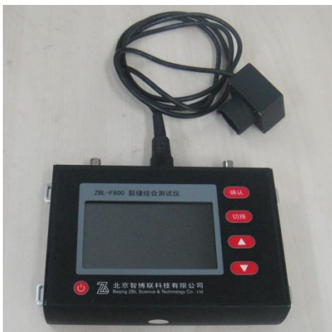
图 4.2 裂缝宽度测试
