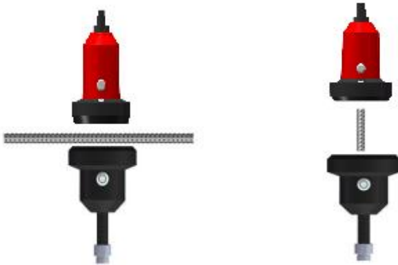
a)钢筋平行于发射探头表面 b) 钢筋垂直于发射探头表面
