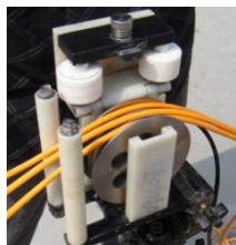
b) 信号线入槽
