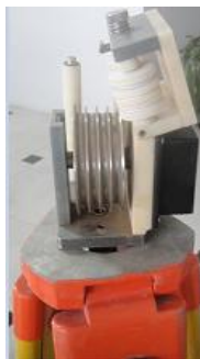
图 9.3 深度记录装置安装
