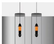
声波透射法测桩
