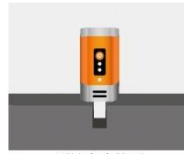
裂缝宽度检测
